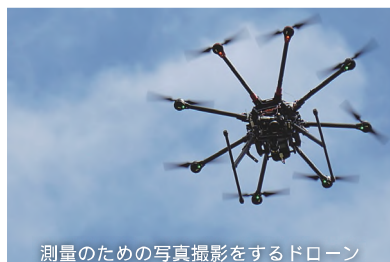
測量のための写真撮影をするドローン
